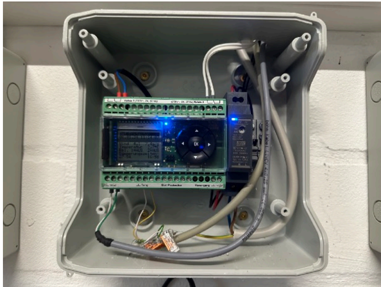
Abbildung Anschluss von Wind / GND des Windmonitor an die Fledermausbox
